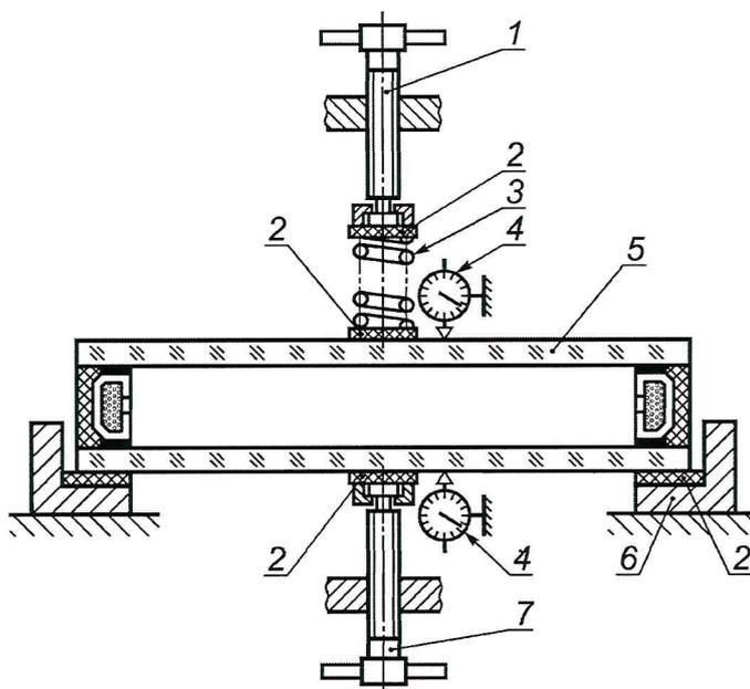
1 — верхний нагрузочный винт; 2 — прокладка; 3 — пружина; 4 — индикатор часового типа; 5 — стеклопакет;
