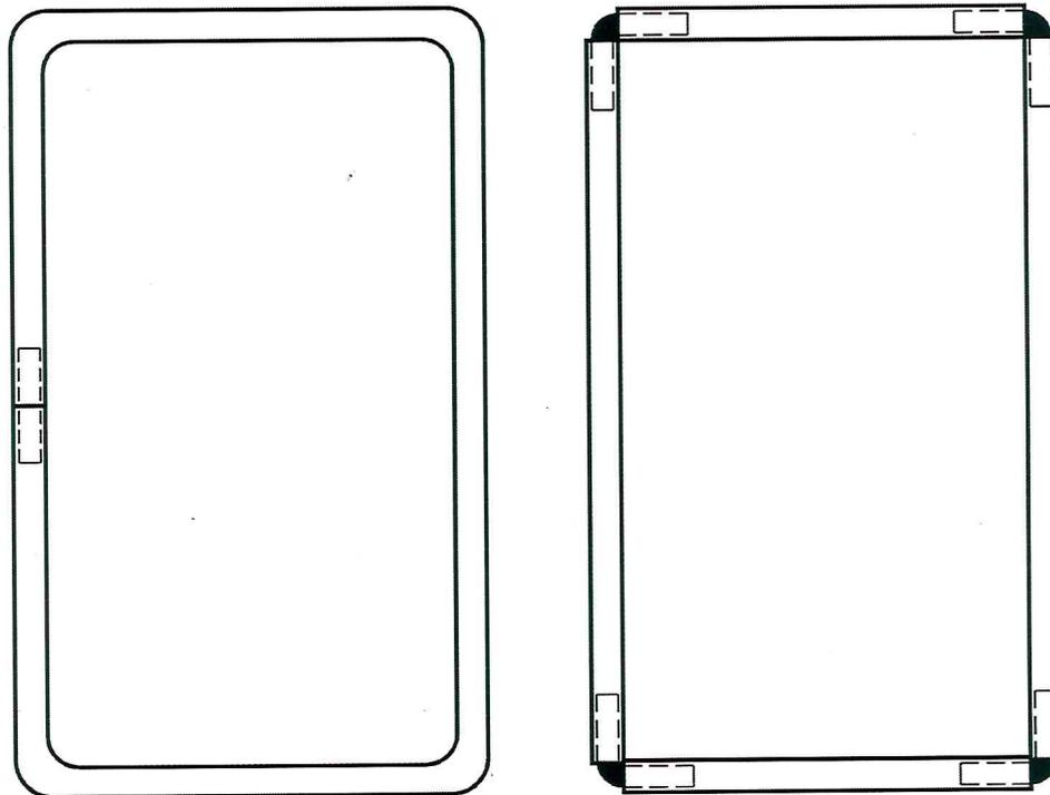
а) Дистанционная рамка; изготовлена методом гнутья и замкнута на одном соединителе (или нескольких соединителях)
