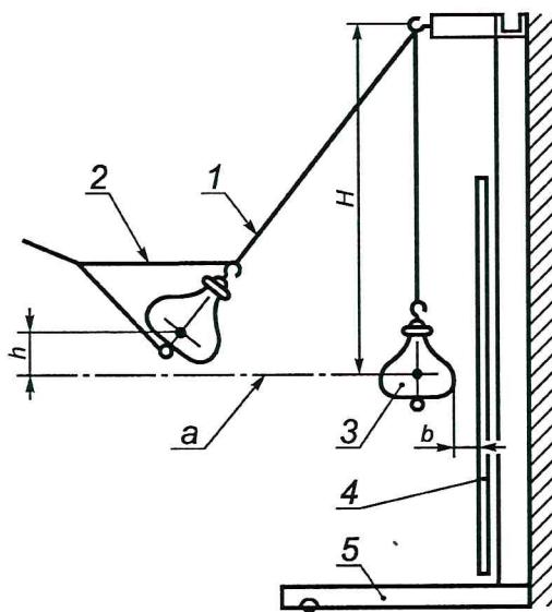
1 — трос; 2 — узелка для подъема мешка; 3 — кожаный мешок (мягкое тело); 4 — испытываемый образец; 5 — опора;
