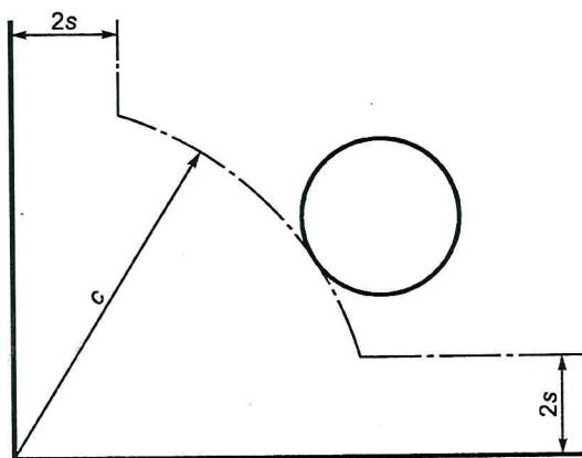
*c* — расстояние от угла листа стекла до кромки отверстия не менее  $6s$ , мм ( $s$  — номинальная толщина стекла, мм)
