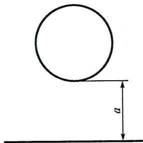
*a* — расстояние от кромки стекла до кромки отверстия не менее  $2s$ , мм ( $s$  — номинальная толщина стекла, мм)
