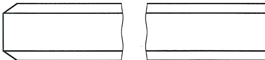
Рисунок А.4 — Полированная кромка
