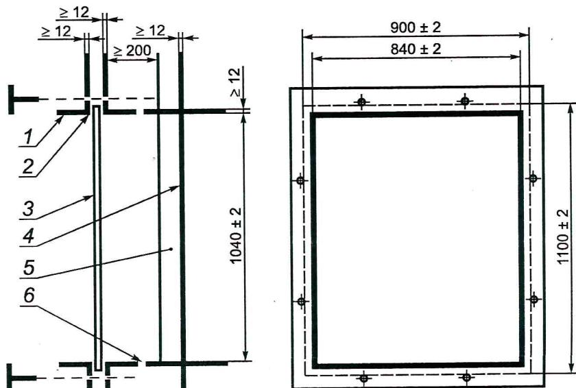
1 — зажимающая рама; 2 — резиновая полоса; 3 — испытываемый образец; 4 — жесткая стальная рама;
