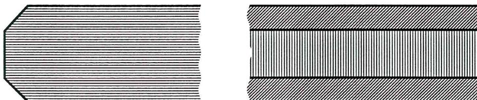
Рисунок А.3 — Гладкошлифованная кромка
